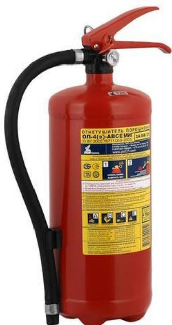
Порошковый огнетушитель ОП-4 (з)-АВСЕ «МИГ» с повышенной огнетушащей способностью закачанный осушенным азотом до давления 16 атм.; ранг огнетушителя – 2А, 70В, С, Е, марка порошка – «Вексон-АВС 25», вес огнетушащего порошка – 4 кг, объем баллона – 5 л, время подачи огнетушащего вещества – 10 секунд.
