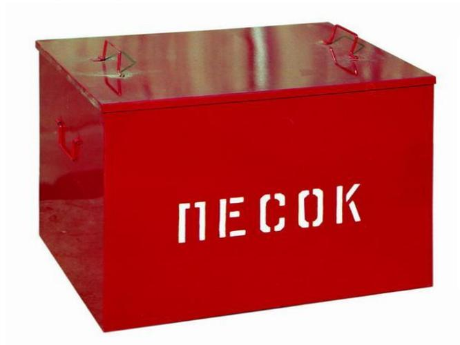
Применяется для механического сбивания пламени и изоляции, горящего или тлеющего материала от окружающего воздуха. Песок подается в очаг пожара лопатой или совком.
