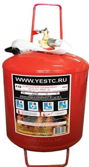
Порошковый огнетушитель ОП-25, закачанный огнетушащим порошком и газом (воздух, азот, углекислый газ) до давления 16 атм.; ранг огнетушителя – 6А, 233В, С, Е, вес огнетушащего порошка – 25 кг, объем баллона – 25 л, время подачи огнетушащего вещества – 20 секунд.
